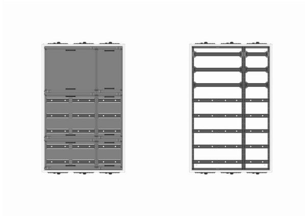
UVK3-8-210-S Automatenverteiler, UVK, BxHxT = 800x1250x210 Schutzklasse II, IP41, RAL 9016, Unterputz Bestehend aus: Gehäuse, Doppeltür mit Drehriegel, Flansche NF1 (oben) und NF2 (unten), 1x Geräteträger 2-Feld breit 3/5 mit Feldabdeckungen PRL, 1x Geräteträger 1-Feld breit 3/5 mit Feldabdeckungen PRL
