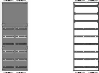
UVK2-9-210-PAutomatenverteiler, UVK, BxHxT = 550x1400x210 Schutzklasse II, IP41, RAL 9016, Unterputz Bestehend aus: Gehäuse, Einzeltür mit Drehriegel, Flansche NF1 (oben) und NF2 (unten), 1x Geräteträger 2-Feld breit 3/6 mit Feldabdeckungen PS
