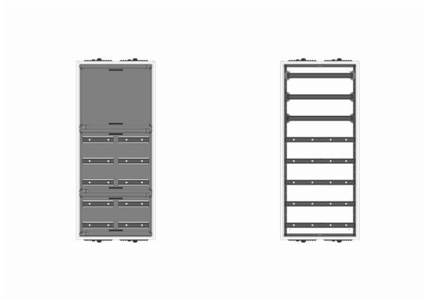
UVK2-8-210 Automatenverteiler, UVK, BxHxT = 550x1250x210 Schutzklasse II, IP41, RAL 9016, Unterputz
