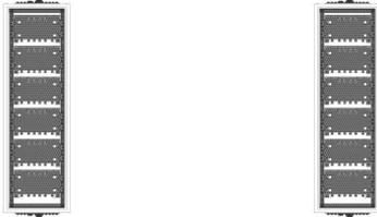
UVK1-6-210-M1 Automatenverteiler, UVK, BxHxT = 300x950x210 Schutzklasse II, IP41, RAL 9016, Unterputz Bestehend aus: Gehäuse, Einzeltür mit Drehriegel, Flansche NF1 (oben) und NF2 (unten), 1x Montageplatte 1-Feld breit
