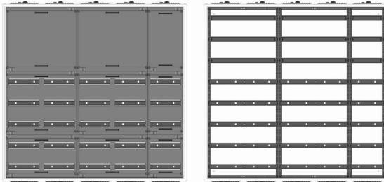
UVB5-8-210-S Automatenverteiler, UVB, BxHxT = 1300x1250x210 Schutzklasse I, IP41, RAL 9016, Unterputz
