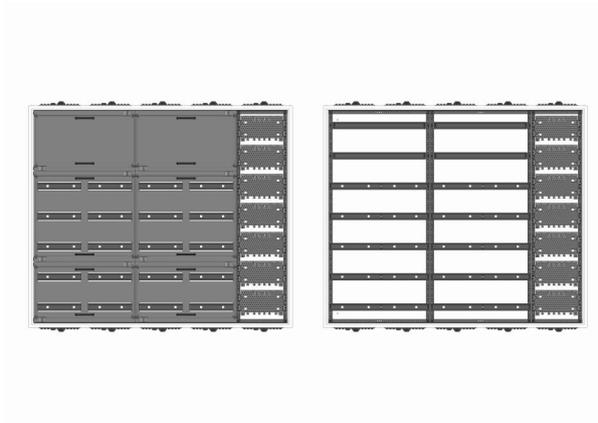
UVB5-7-210-M1 Automatenverteiler, UVB, BxHxT = 1300x1100x210 Schutzklasse I, IP41, RAL 9016, Unterputz Bestehend aus: Gehäuse, Doppeltür mit Drehriegel, Flansche NF1 (oben) und NF2 (unten), 2x Geräteträger 2-Feld breit 2/5 mit Feldabdeckungen PRL, 1x Montageplatte 1-Feld breit
