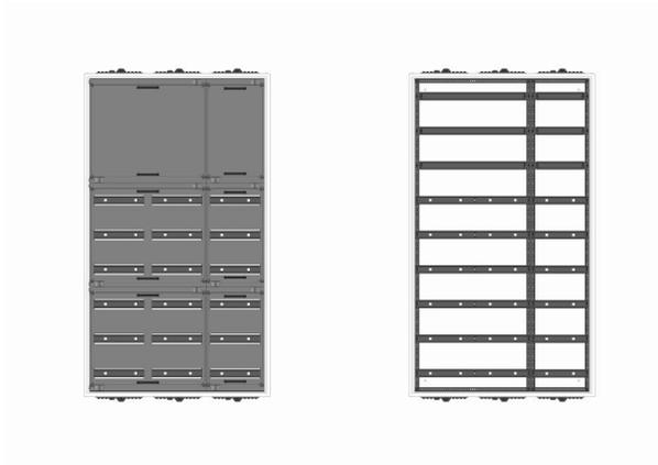
UVB3-9-210-S Automatenverteiler, UVB, BxHxT = 800x1400x210 Schutzklasse I, IP41, RAL 9016, Unterputz Bestehend aus: Gehäuse, Doppeltür mit Drehriegel, Flansche NF1 (oben) und NF2 (unten), 1x Geräteträger 2-Feld breit 3/6 mit Feldabdeckungen PRL, 1x Geräteträger 1-Feld breit 3/6 mit Feldabdeckungen PRL
