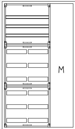
UVB3-9-210-M1-PAutomatenverteiler, UVB, BxHxT = 800x1400x210Schutzklasse I, IP41, RAL 9016, UnterputzBestehend aus:Gehäuse, Doppeltür mit Drehriegel, Flansche NF1 (oben) und NF2 (unten), 1x Geräteträger 2-Feld breit 3/6 mit Feldabdeckungen PS, 1x Montageplatte 1-Feld breit
