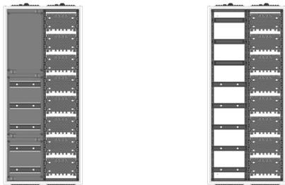
UVB2-8-210-M1-PAutomatenverteiler, UVB, BxHxT = 550x1250x210Schutzklasse I, IP41, RAL 9016, UnterputzBestehend aus:Gehäuse, Einzeltür mit Drehriegel, Flansche NF1 (oben) und NF2 (unten), 1x Geräteträger 1-Feld breit 3/5 mit Feldabdeckungen PS, 1x Montageplatte 1-Feld breit
