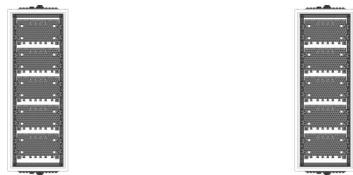
UVB1-5-210-M1 Automatenverteiler, UVB, BxHxT = 300x800x210 Schutzklasse I, IP41, RAL 9016, Unterputz Bestehend aus: Gehäuse, Einzeltür mit Drehriegel, Flansche NF1 (oben) und NF2 (unten), 1x Montageplatte 1-Feld breit
