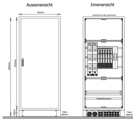
SVKNH2-6-3-12-360 M-Standverteilung, SVK, BxHxT = 820x1870+130x360 Schutzklasse II, IP54, RAL 7035 Bestehend aus: Gehäuse, Sockel, Einzeltür mit Schwenkhebel für PHZ, Flansche SF32 (oben) und 2x KFL2-240, 4x KFL2-4/35 (unten), komplettem Geräteträger mit Feldabdeckungen PRL, Wandhalterung
