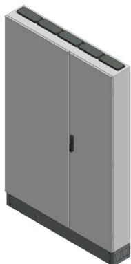
SVK5-12-230Standverteilung, SVK, BxHxT = 1300x1850+150x230Schutzklasse II, IP54, RAL 7035Bestehend aus:Gehäuse, Sockel, Doppeltür mit Schwenkhebel für PHZ, Flansche SF45 (oben) und SF41 (unten), komplettem Geräteträger mit Feldabdeckungen PRL, Wandhalterung
