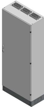
SVK3-12-400 Standverteilung, SVK, BxHxT = 820x1870+130x400 Schutzklasse II, IP54, RAL 7035 Bestehend aus: Gehäuse, Sockel, Einzeltür mit Schwenkhebel für PHZ, Flansche SF31 (oben) und SF32 (unten), komplettem Geräteträger mit Feldabdeckungen PRL, Wandhalterung
