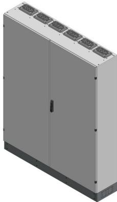
SVB6-12-360 Standverteilung, SVB, BxHxT = 1570x1870+130x360 Schutzklasse I, IP54, RAL 7035 Bestehend aus: Gehäuse, Sockel, Doppeltür mit Schwenkhebel für PHZ, Flansche SF31 (oben) und SF32 (unten), komplettem Geräteträger mit Feldabdeckungen PRL, Wandhalterung
