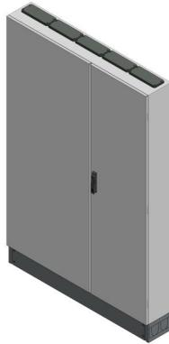
SVB5-12-230 Standverteilung, SVB, BxHxT = 1300x1850+150x230 Schutzklasse I, IP54, RAL 7035 Bestehend aus: Gehäuse, Sockel, Doppeltür mit Schwenkhebel für PHZ, Flansche SF45 (oben) und SF41 (unten), komplettem Geräteträger mit Feldabdeckungen PRL, Wandhalterung
