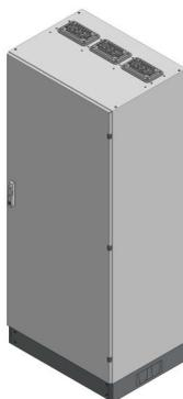
SVB3-12-600 Standverteilung, SVB, BxHxT = 820x1870+130x600 Schutzklasse I, IP54, RAL 7035 Bestehend aus: Gehäuse, Sockel, Einzeltür mit Schwenkhebel für PHZ, Flansche SF31 (oben) und SF32 (unten), komplettem Geräteträger mit Feldabdeckungen PRL, Wandhalterung
