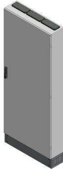
SVB3-12-230 Standverteilung, SVB, BxHxT = 800x1850+150x230 Schutzklasse I, IP54, RAL 7035 Bestehend aus: Gehäuse, Sockel, Einzeltür mit Schwenkhebel für PHZ, Flansche SF45 (oben) und SF41 (unten), komplettem Geräteträger mit Feldabdeckungen PRL, Wandhalterung
