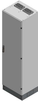
SVB2-12-500 Standverteilung, SVB, BxHxT = 570x1870+130x500 Schutzklasse I, IP54, RAL 7035 Bestehend aus: Gehäuse, Sockel, Einzeltür mit Schwenkhebel für PHZ, Flansche SF31 (oben) und SF32 (unten), komplettem Geräteträger mit Feldabdeckungen PRL, Wandhalterung
