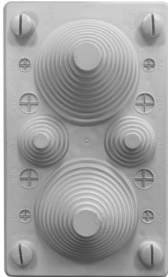
SF39 Membranflansch für Kabeldurchmesser: 4x7-12mm; 4x12-18mm; 2x7-33mm;
