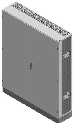
RSVK6-12-400 Reihenschaltschrank, RSVK, BxHxT = 1570x1870+130x400 Schutzklasse II, IP54, RAL 7035 offene Seitenwände, Seitenwandprofil gekantet, für Schrankverbindung Bestehend aus: Gehäuse, Sockel, Doppeltür mit Schwenkhebel für PHZ, Flansche SF31 (oben) und SF32 (unten), komplettem Geräteträger mit Feldabdeckungen PRL, Wandhalterung
