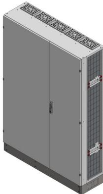
RSVK5-12-400Reihenschaltschrank, RSVK, BxHxT = 1320x1870+130x400Schutzklasse II, IP54, RAL 7035offene Seitenwände, Seitenwandprofil gekantet, für SchrankverbindungBestehend aus:Gehäuse, Sockel, Doppeltür mit Schwenkhebel für PHZ, Flansche SF31 (oben) und SF32 (unten), komplettem Geräteträger mit Feldabdeckungen PRL, Wandhalterung
