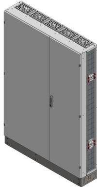
RSVK5-12-300Reihenschaltschrank, RSVK, BxHxT = 1320x1870+130x300Schutzklasse II, IP54, RAL 7035offene Seitenwände, Seitenwandprofil gekantet, für SchrankverbindungBestehend aus:Gehäuse, Sockel, Doppeltür mit Schwenkhebel für PHZ, Flansche SF35 (oben) und SF32 (unten), komplettem Geräteträger mit Feldabdeckungen PRL, Wandhalterung
