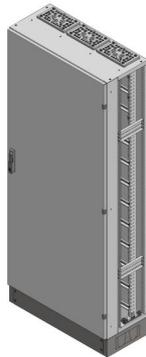
RSVB3-12-360Reihenschaltschrank, RSVB, BxHxT = 820x1870+130x360Schutzklasse I, IP54, RAL 7035, offene Seitenwände, Seitenwandprofil gekantet, für SchrankverbindungBestehend aus:Gehäuse, Sockel, Einzeltür mit Schwenkhebel für PHZ, Flansche SF31 (oben) und SF32 (unten), komplettem Geräteträger mit Feldabdeckungen PRL, Wandhalterung
