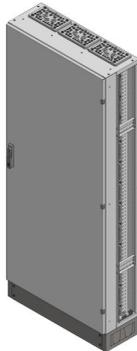
RSVB3-12-300Reihenschaltschrank, RSVB, BxHxT = 820x1870+130x300Schutzklasse I, IP54, RAL 7035, offene Seitenwände, Seitenwandprofil gekantet, für SchrankverbindungBestehend aus:Gehäuse, Sockel, Einzeltür mit Schwenkhebel für PHZ, Flansche SF35 (oben) und SF32 (unten), komplettem Geräteträger mit Feldabdeckungen PRL, Wandhalterung
