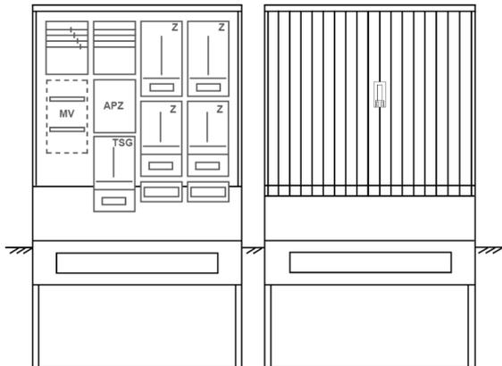
Zähleranschluss säule für den Außenbereich mit Regendach,
