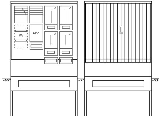
Zähleranschlussäule für den Außenbereich mit Regendach,
