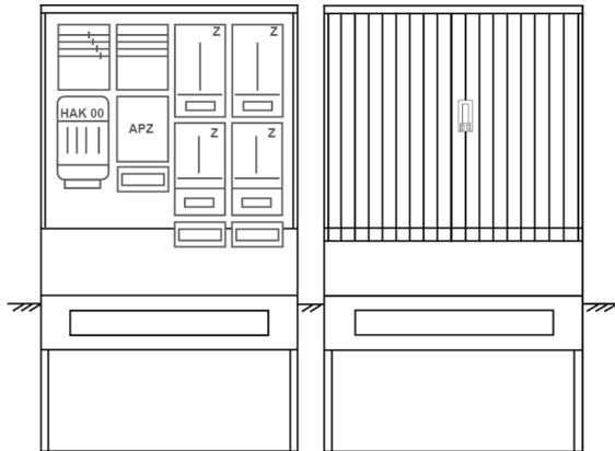
Zähleranschlussssäule für den Außenbereich mit Regendach,
