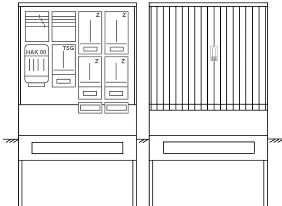
Zähleranschlusssäule für den Außenbereich mit Regendach,
