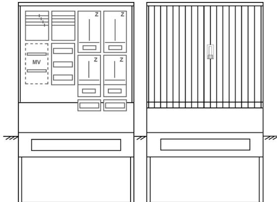
Zähleranschlusssäule für den Außenbereich mit Regendach,
