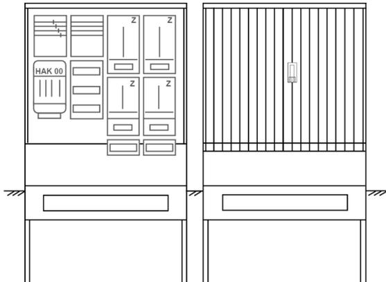
Zähleranschlusssäule für den Außenbereich mit Regendach,
