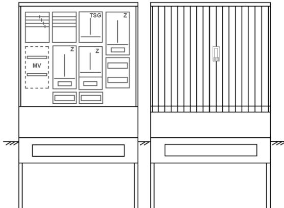
Zähleranschlussäule für den Außenbereich mit Regendach,
