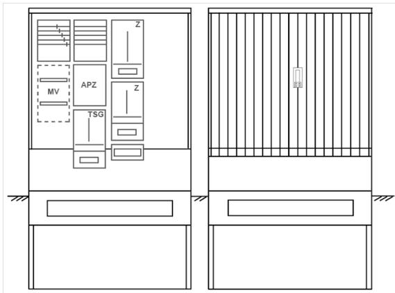
Zähleranschlussssäule für den Außenbereich mit Regendach,
