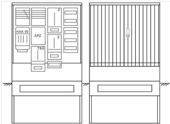
Zähleranschlussssäule für den Außenbereich mit Regendach,
