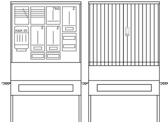
Zähleranschlussssäule für den Außenbereich mit Regendach,
