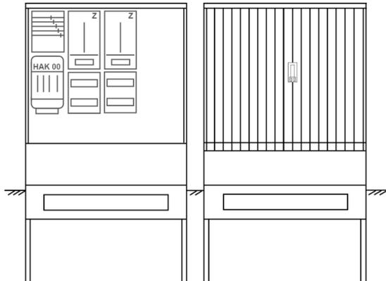
Zähleranschluss säule für den Außenbereich mit Regendach,
