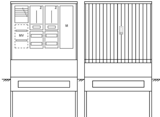
Zähleranschlusssäule für den Außenbereich mit Regendach,
