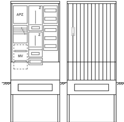
Zähleranschluss säule für den Außenbereich mit Regendach,
