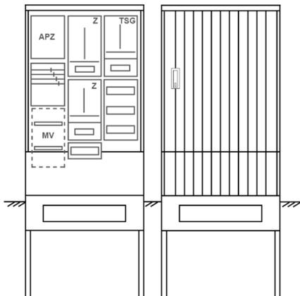
Zähleranschlusssäule für den Außenbereich mit Regendach,
