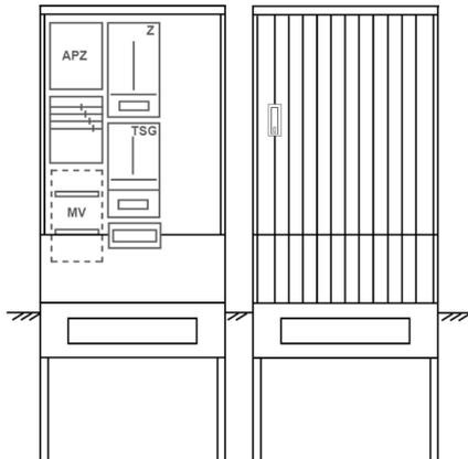
Zähleranschluss säule für den Außenbereich mit Regendach,
