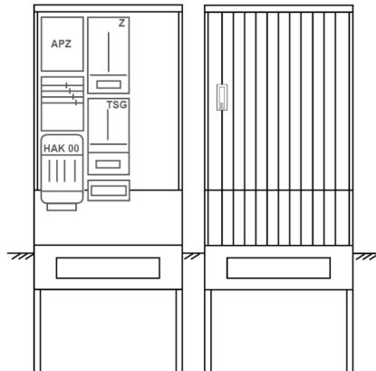
Zähleranschlussäule für den Außenbereich mit Regendach,
