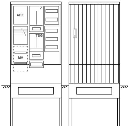
Zähleranschlusssäule für den Außenbereich mit Regendach,
