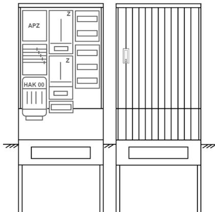
Zähleranschluss säule für den Außenbereich mit Regendach,
