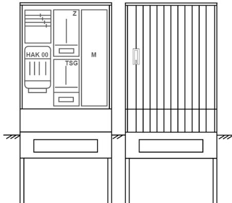
Zähleranschlusssäule für den Außenbereich mit Regendach,
