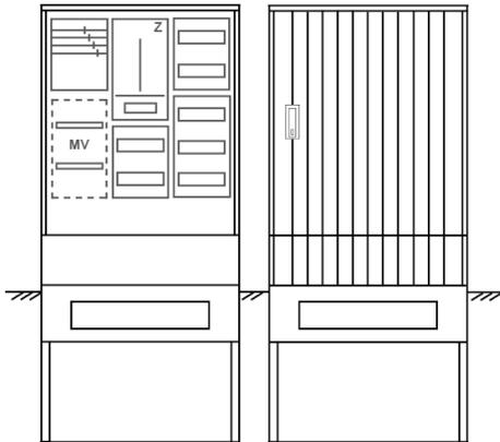
Zähleranschlusssäule für den Außenbereich mit Regendach,
