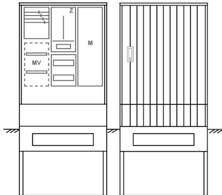
Zähleranschlusssäule für den Außenbereich mit Regendach,
