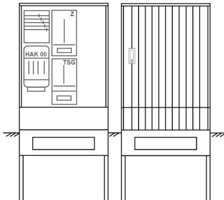
Zähleranschlussäule für den Außenbereich mit Regendach,
