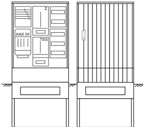
Zähleranschluss säule für den Außenbereich mit Regendach,
