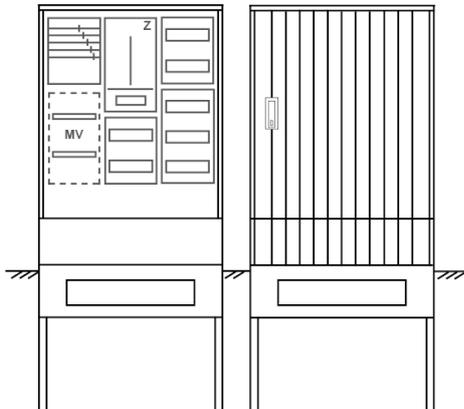
Zähleranschlussssäule für den Außenbereich mit Regendach,
