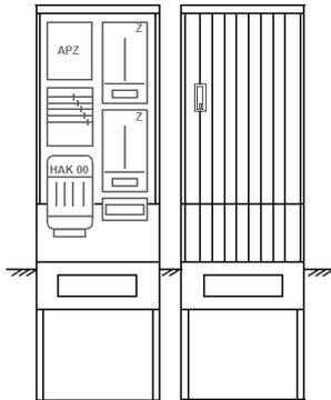
Zähleranschlusssäule für den Außenbereich mit Regendach,
