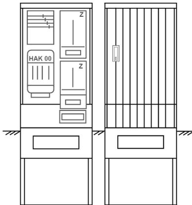
Zähleranschlusssäule für den Außenbereich mit Regendach,
